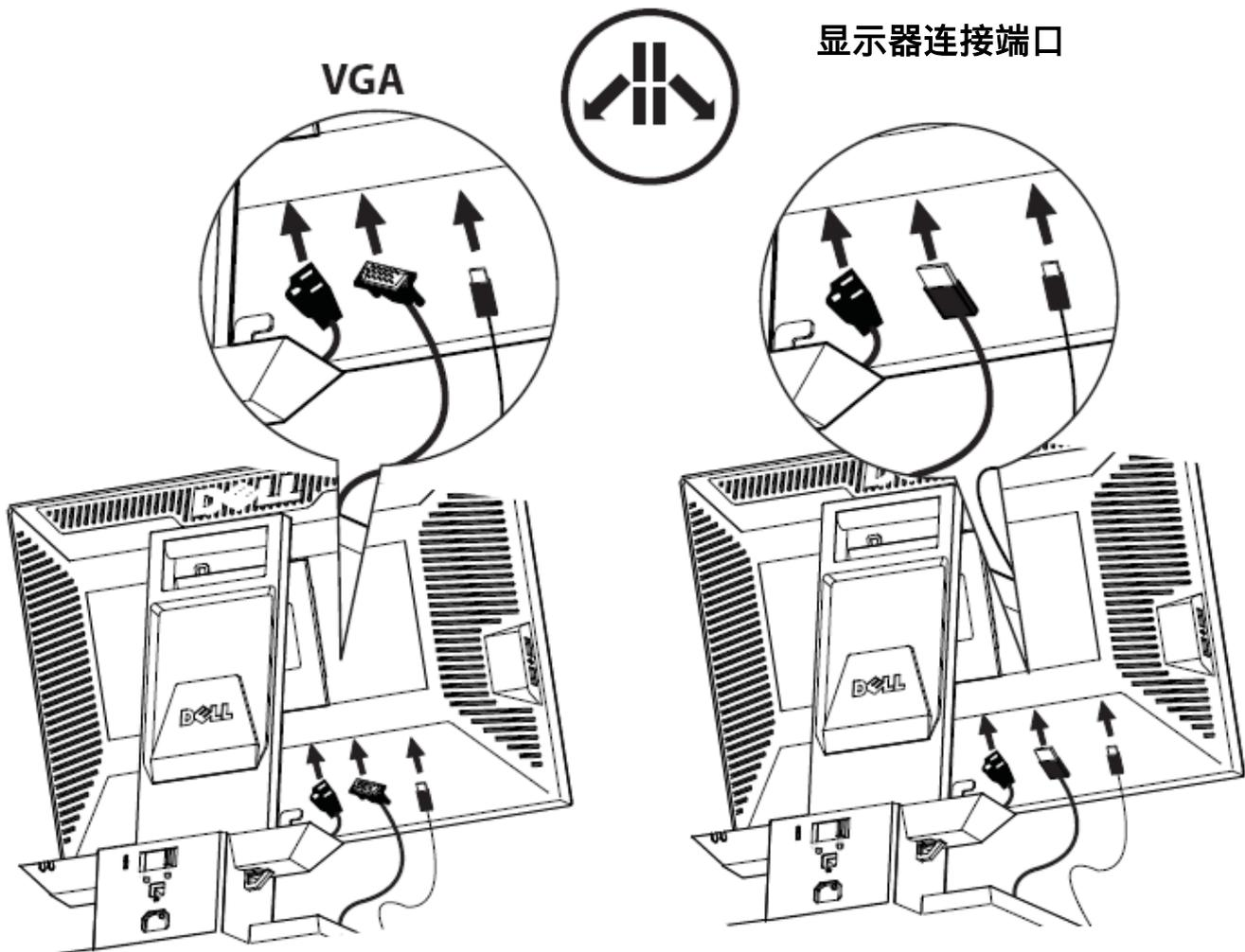
**5** 将配件缆线（键盘、鼠标、喇叭等）穿过电缆线槽。
